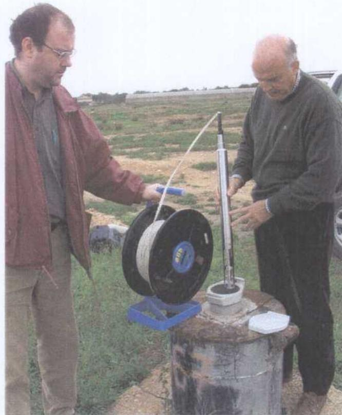
Se procede a seleccionar un determinado número de sondeos, en los que antes de hacer el registro se debe testar su validez, es decir, comprobar la profundidad real del sondeo y la posible problemática en la vertical del pozo, utilizando para esto una sonda lastre que advierta
